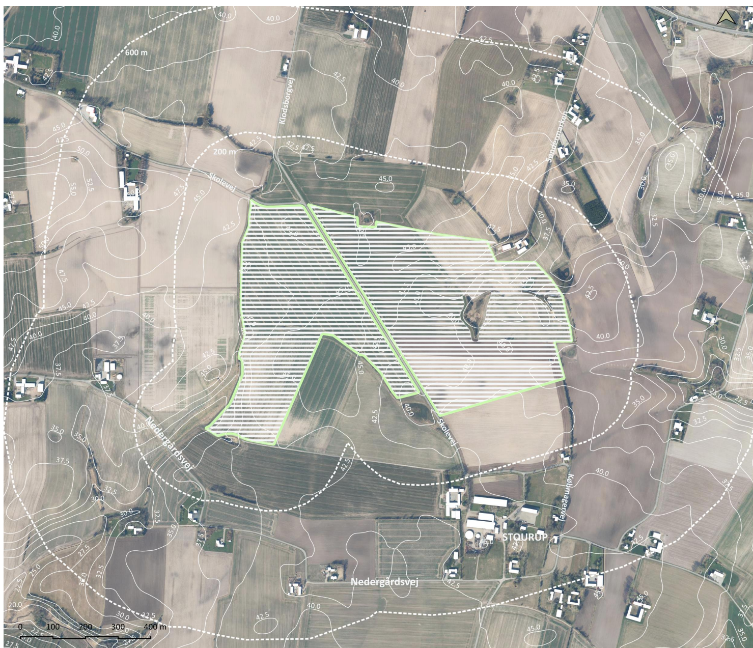
Kort 7.3: Plan- og projektområdets placering i forhold til omkringliggende boliger. Desuden fremgår eksisterende beplantning af luftfotoet. Terræforholdene er vist med 2,5 m terræncurver. Områder til solceller er vist med hvid skravering og beplantningsbælter med grøn streg.
