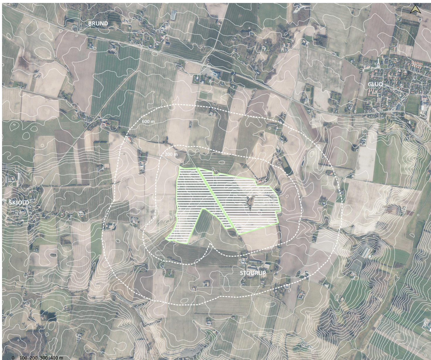
Kort 7.4: Plan- og projektområdets placering vist i forhold til omkringliggende byer. Terrænforholdene er vist med 2,5 m terrænkurver. Områder til solceller er vist med hvid skravering og beplantningsbælter med grøn streg.
