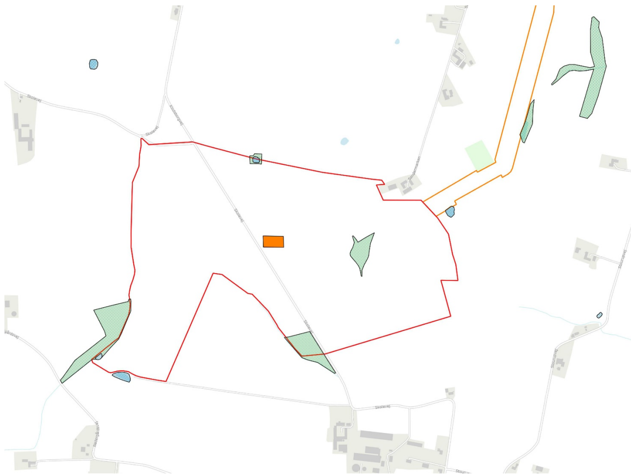
Kort 6.2: Plan- og projektområdet for solcelleanlægget (rød afgrænsning), transformerstationen (orange) og traceet for anlæggets nettilslutning (orange afgrænsning) i forhold til forekomsten af §3-beskyttede søer (blå) og enge (grøn) i og omkring området.
